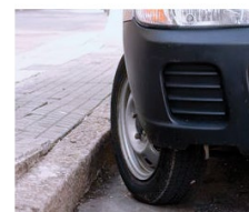
Disposición correcta de las ruedas al estacionar en repecho.
